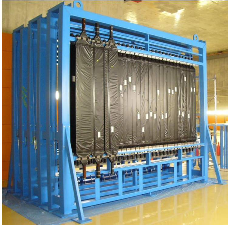
図 1.3.5 現在建設中の中性子検出器 NEBULA の写真。青色の枠は各モジュールを支えるための架台で、手前左側に設置されている黒い縦長のモジュールは”VETO”と呼ばれる荷電粒子と中性子を識別するためのモジュールで、その奥に設置されているのは中性子検出器本体である。完成すると、中性子検出器本体の前面を覆うように VETO が設置され、さらに三つの架台に同様にモジュールが設置される。
