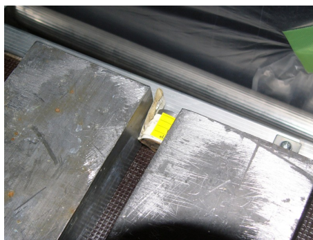
図 3.5: ^{241}\text{AmBe} 線源 (中央) およびコリメーション用の鉛ブロック。上方の黒い部分は NEBULA シンチレータ (遮光シートの黒)
