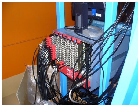
図 2.8: 電源 SY1527LC(メインフレーム),A1535SN(ボード) 及び結線された SHV ケーブル
