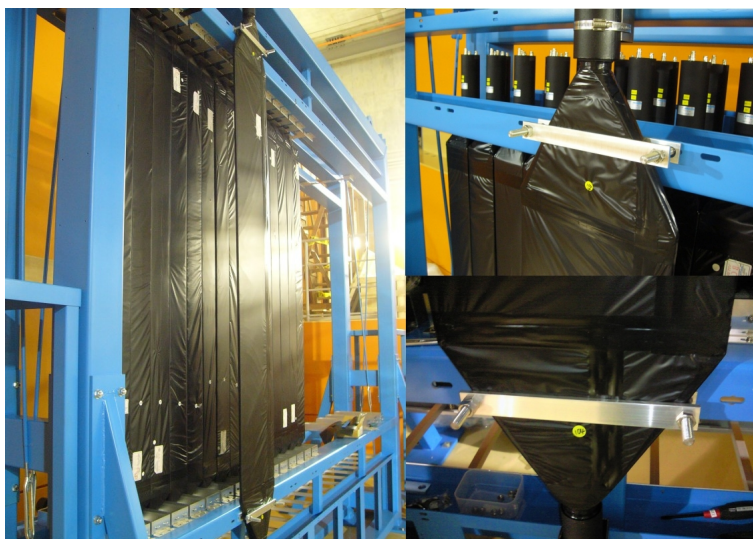
図 2.6: 磁気シールドが装着された VETO 検出器用光電子増倍管。赤丸で囲まれたものは装着準備をしているところで、絶縁用のカプトンフィルムが巻き付けられている。
