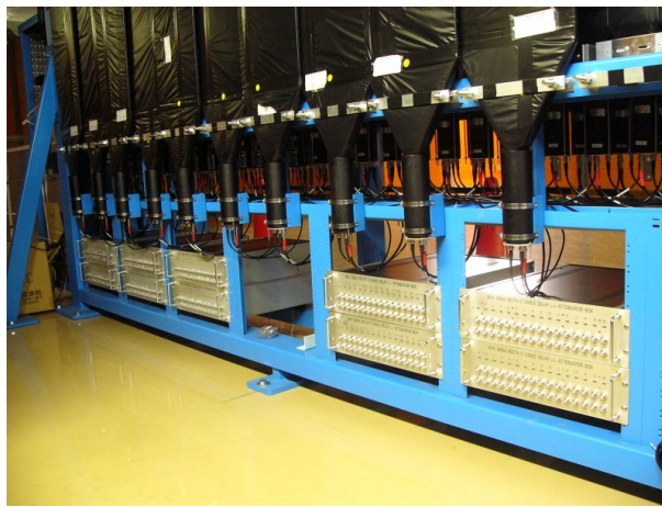
図 2.10: 結線された 2 台の回路ラック。左右どちらのラックにも、上から順に BNC-LEMO 変換パネル、VME クレート、NIM ピンがマウントされている。
