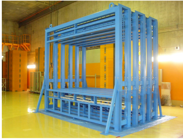
図 2.3: NEBULA の架台 (2-4 番)。この架台にシンチレータ、電源、回路など、NEBULA を構成する殆ど全てを搭載する。ただしこの写真では回路用のラックは取り付けられていない。
