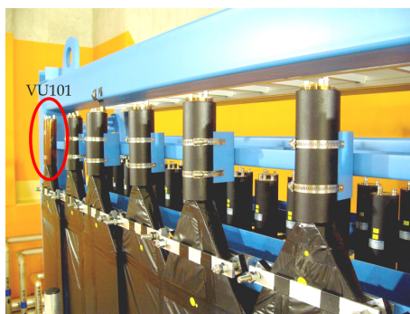
図 2.6: 磁気シールドが装着された VETO 検出器用光電子増倍管。赤丸で囲まれたものは装着準備をしているところで、絶縁用のカプトンフィルムが巻き付けられている。
