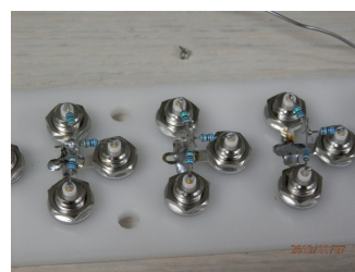
図 3.7 スプリッターの内部の抵抗の画像。抵抗はハンダ付けで互いに接着させた
