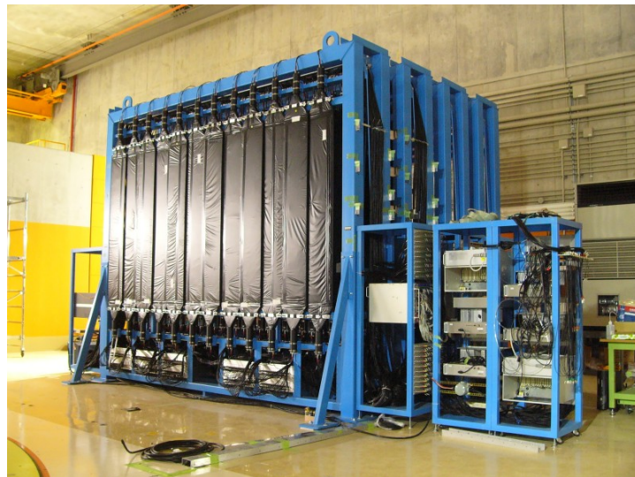
図 2.4 NEBULA をビームの上流側から撮影したもの。VETO が前面に設置されており、その後ろに 120 本のコモジュールが 2 層に組み立てられている。
