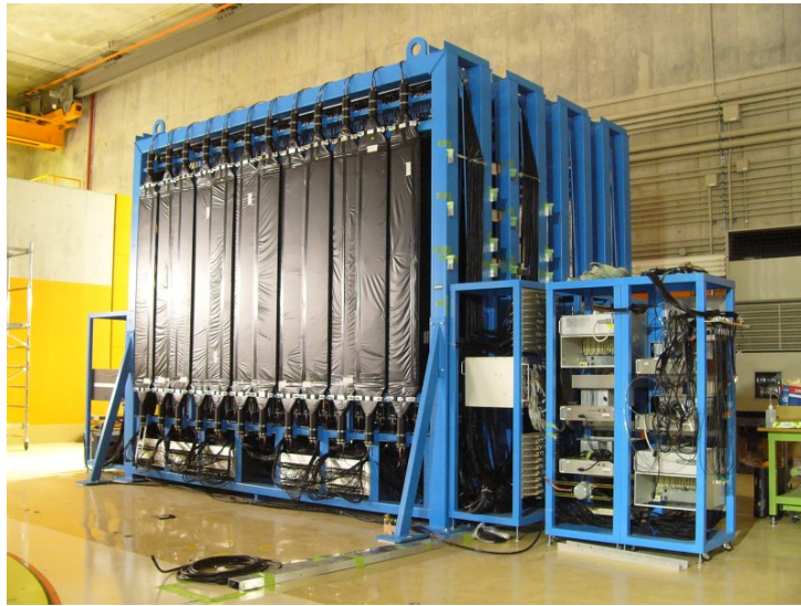
図 2.4.1 NEBULA の概観 (撮影: 佐古貴行)。NEBULA は NEUT、VETO とともに縦置きとなっており、1 架台目に 12 本の VETO と 30 本 × 2 層の NEUT、2 架台目も同様に検出器が積まれている。図中下側に見えるのはケーブルディレイ、右側に見えるのは信号処理回路である。
