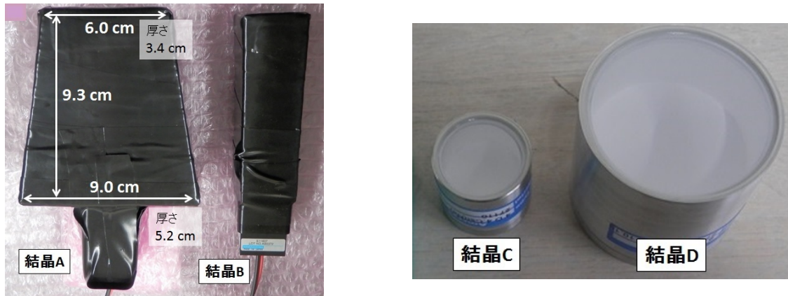
図 4.1 CsI(Tl) 結晶と CsI(Na) 結晶の写真
