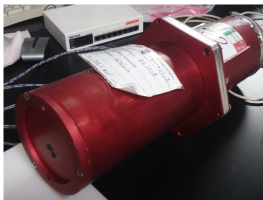
図 2.8 本研究で用いた \text{LaBr}_3(\text{Ce}) 結晶 (3.5 inch \phi \times 8 inch) の写真。後方に PMT が接続されている
