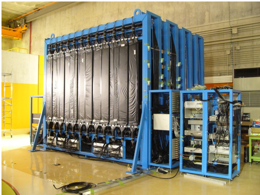
図 2.1 NEBULA の外観。現在は手前 2 架台のみを実験に用いている。VETO が一番手前に見えていて、NEUT は写真からは直接見るできない。また、シンチレータの下及び右側にエレクトロニクス部の一部が見えている。写真は佐古氏 [15] による。
