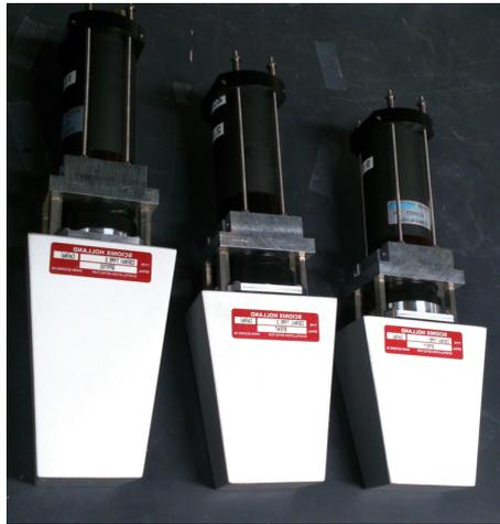
図 3.10: 結晶と PMT を接着した写真。結晶の種類は左から、図 3.5 の緑色、水色、青色の結晶に対応する。
