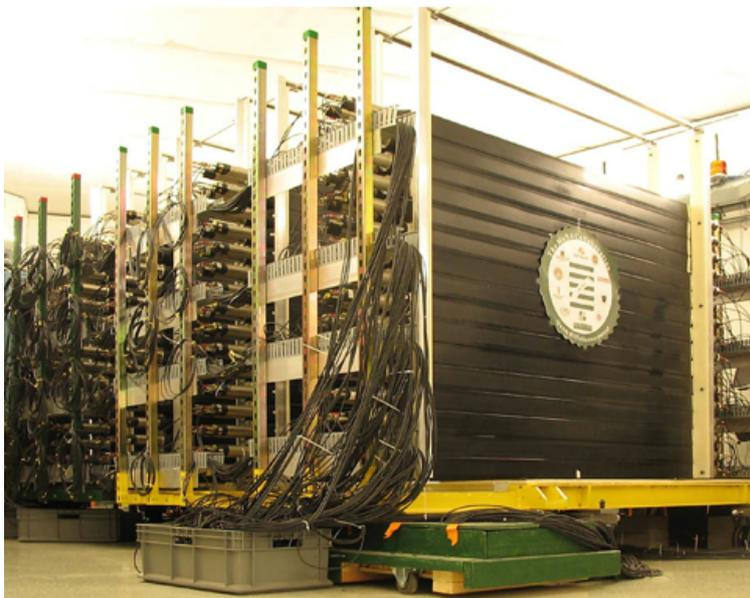
図 2.8 MoNA の全体図 [18]。10 cm × 200 cm の面でビームを検知する。ビーム軸方向に対する厚さは 10 cm である。
