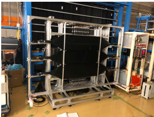
図 3.5 アップグレード前後の HIME の外観。(左)HIME が 48 本の NEUT で構成されていたときの外観 (上流側から撮影)。前実験のセットアップに合わせて高さの低い架台を使用しており、回路系は隣接するラックに取り付けていた。(右) 今回のアップグレードにより NEUT が 100 本となった HIME(上流側から撮影)。VETO を外しており、ケーブルを取り付ける前の写真。2 つの Wall で構成されており、架台部分にすべての回路が取り付けられている。
