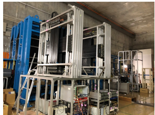
図 3.5 アップグレード前後の HIME の外観。(左)HIME が 48 本の NEUT で構成されていたときの外観 (上流側から撮影)。前実験のセットアップに合わせて高さの低い架台を使用しており、回路系は隣接するラックに取り付けていた。(右) 今回のアップグレードにより NEUT が 100 本となった HIME(上流側から撮影)。VETO を外しており、ケーブルを取り付ける前の写真。2 つの Wall で構成されており、架台部分にすべての回路が取り付けられている。
