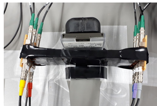
図 4.16: 実際のセッティングの写真。中央の黒い物体が遮光されたシンチレータ。写真左側が L 側、右側が R 側となる。シンチレータからおよそ 1cm 離れた位置に ^{137}\text{Cs} 線源を置いた。
