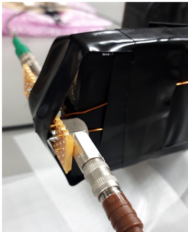
図 5.11: 実験 2 で 1 個の MPPC を固定した状態。基板の穴に通したワイヤーをテープで固定するのに加えて基板の上からテープを張り付け、そのテープをシンチレータの側面に張り付けている。この固定方法そのものは実験 1 での片側 4 個の MPPC の固定方法と同様である。
