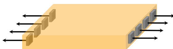
図 4.1: プロトタイプ検出器の概念図。黄色直方体はシンチレータを、灰色直方体は MPPC を表す。シンチレータの周りにはアルミナ イズドマイラーと黒シートで遮光を施している。
