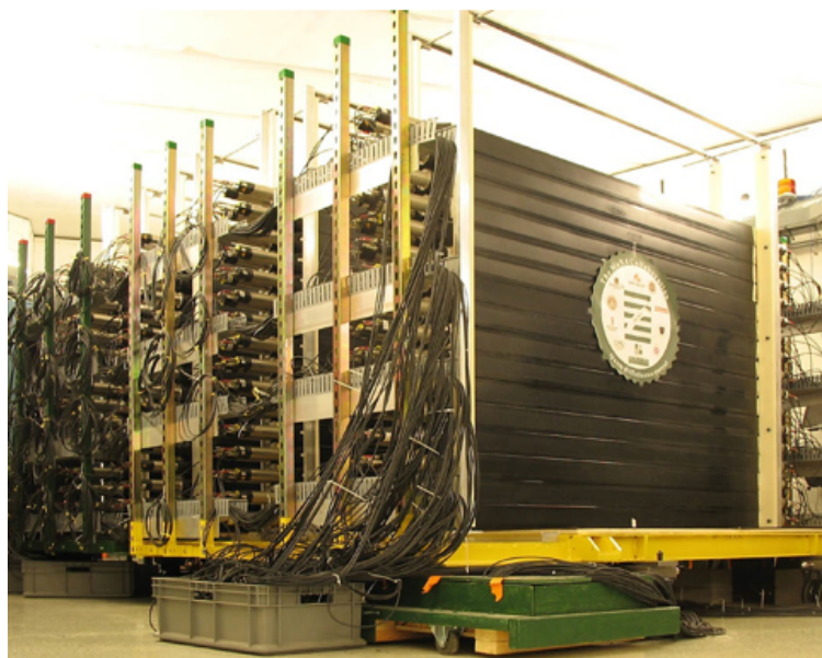
図 2.8 MoNA の全体図 [24]。100 mm × 2000 mm の面でビームを検知する。ビーム軸方向に対する厚さは 100 mm である。
