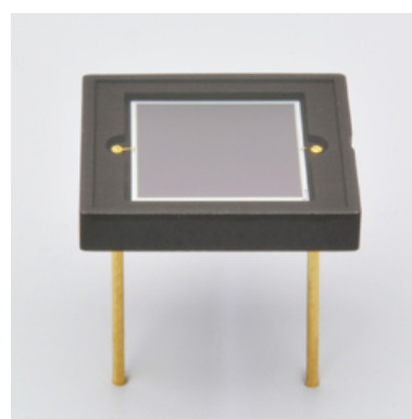
図 2.10: 浜松ホトニクス製の MPPC(S13360-6075CS)
