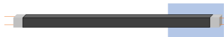
図 3.4: 検出器の模式図。黒い直方体がプラスチックシンチレータで、灰色の直方体が MPPC、青色の四角形がヒーターユニットを表す。
