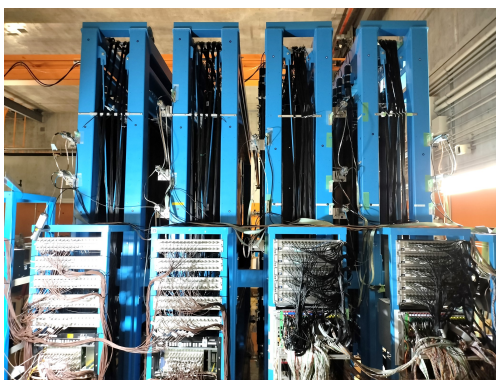
図 3.2 NEBULA の概観 (側面)。右側 2 架台が従来の NEBULA、左側 2 架台が増設された NEBULA Plus である。
