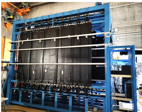
図 3.1 NEBULA の概観 (正面)。正面に VETO 検出器、後ろに中性子検出器が並ぶ。
